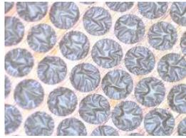
图2. 300目铜网支撑的Si薄膜（无碳膜）。
