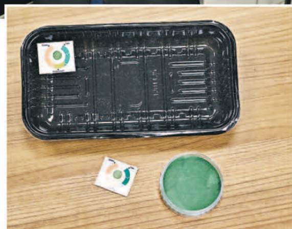
▲保鮮膜上的試紙可根據食品產生的生物胺化學氣體，辨別食品變壞情況。右下綠色的物料是試紙的原材料。
